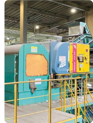
廃プラスチックを選別する光学式選別機
